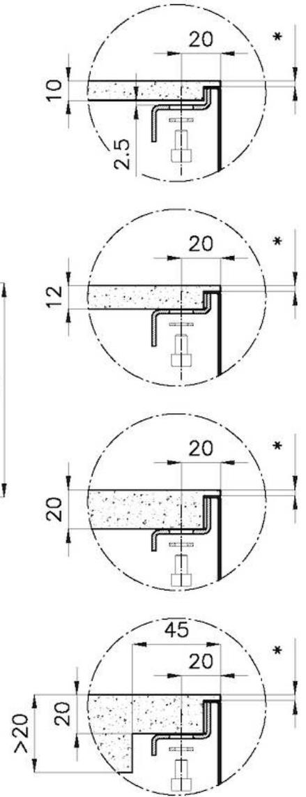
\* Lo spessore minimo deve essere valutato in base alla resistenza del materiale
